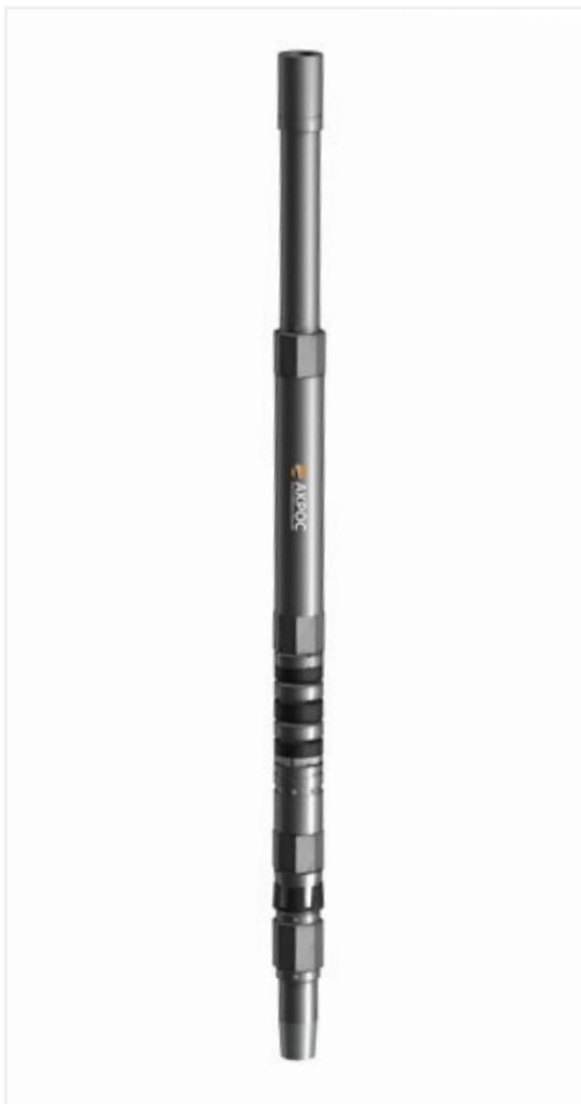
Подвески хвостовика нецементируемые предназначены для проведения спуска потайной обсадной колонны (хвостовика) без проведения цементирования с последующей подвеской спускаемого хвостовика в предыдущей обсадной колонне, разъединением хвостовика от транспортировочной колонны и герметизацией межколонного пространства, также подвески применяются при спуске хвостовика с проведением промывок через башмак. Подвески, после срабатывания, разбуривания не требуют.
