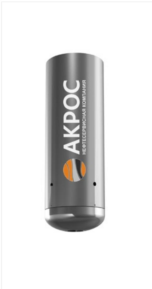
Башмак колонный металлический с обратным клапаном предназначен для направления обсадной колонны по стволу скважины при спуске и предотвращения обратного перетока тампонажного или бурового раствора из заколонного пространства во внутреннее пространство обсадной колонны.
