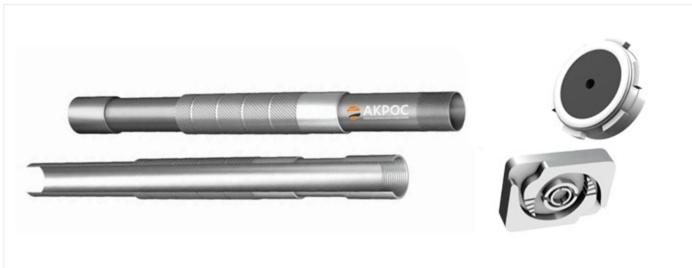
Автономные регуляторы притока устанавливаются в несущую трубу скважинного фильтра и служат для ограничения притока газа и воды в случае их прорыва в скважину, а также для выравнивания профиля притока.
