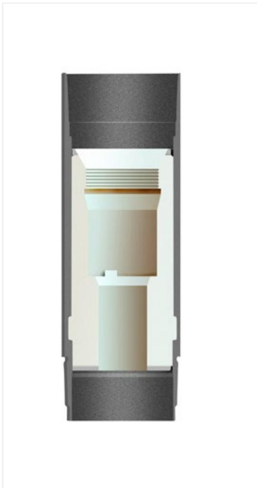
Стоп-патрубок предназначен для получения сигнала об окончании продавливания разделительной пробки при сплошном цементировании хвостовика за счет её герметичной посадки в приемное седло внутри стоп-патрубка.
