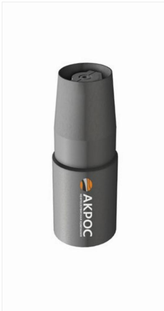
Цементируемый клапан обратный дроссельный с плунжером предназначен для предотвращения обратного перетока тампонажного или бурового раствора из заколонного пространства во внутреннее пространство обсадной колонны.
