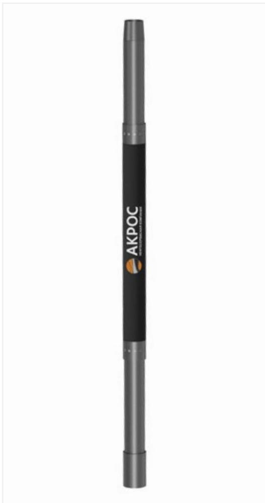
Пакер предназначен для предотвращения межпластовых перетоков и изоляции пластов при повышенных требованиях к герметичности соединений и к удерживаемым перепадам давления в скважинах. Пакер герметично разделяет жидкости в за трубном пространстве.
