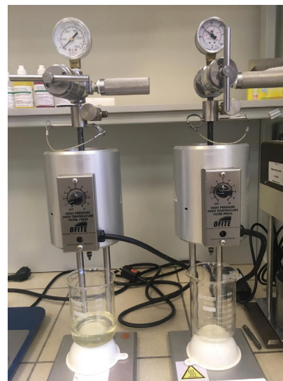
Рис. 7. Фильтрация углеводородом по направлению пласт – скважина при забойных условиях с целью определения восстановления проницаемости модели горной породы: слева – инфильтрация 100 % объема через корку SMART-BLOCK® практически без перепада давления; справа – отсутствие фильтрации УВ через корку базового блок-состава при депрессии 500 psi
