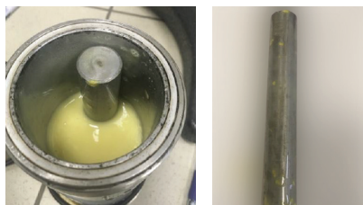
Рис. 3. Тест на адгезию состава к элементам внутрискважинного оборудования
