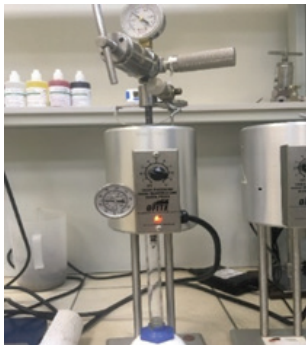
Рис. 4. Фильтрация водной фазы по направлению скважина – пласт: температура – 80 °С; репрессия – 500 psi; проницаемость – 2000 мД
