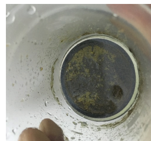
Рис. 8. Тестирование на растворение корки SMART-BLOCK® и ее удаление с поверхности модели пласта. Наблюдается отслаивание корки SMART-BLOCK® с поверхности керамического диска и ее частичное растворение в углеводородной фазе
