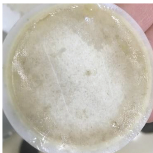
Рис. 2. Тест на смачиваемость фильтрационной корки в модели технической воды
