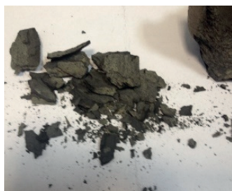
Фрагмент керна. Тайлаковское месторождение, бажендовская свита
